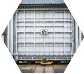
WYŻARZANIE PIEC GAZOWY POZIOMY
